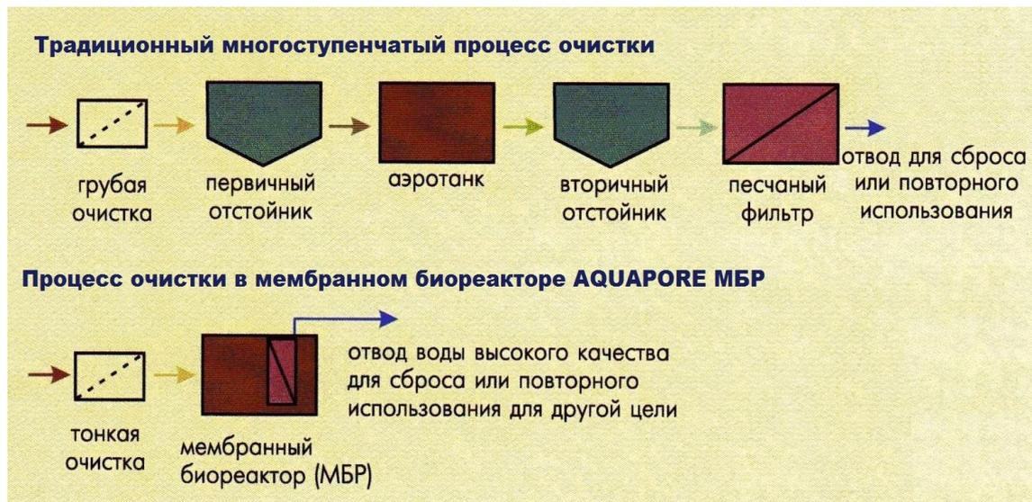
Внедрение технологии MBR для очистки производственных и хозяйственно-бытовых сточных вод коренным образом меняет традиционные схемы очистки и обеспечивает высокую эффективность удаления загрязнений в соответствии с действующим законодательством РК в сфере канализования и очистки сточных вод.
